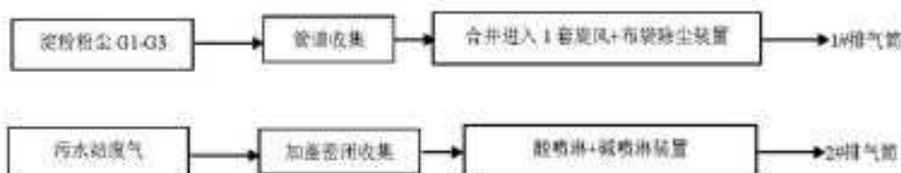
图 4-1 项目各股废气收集、处理、排放路线示意图
