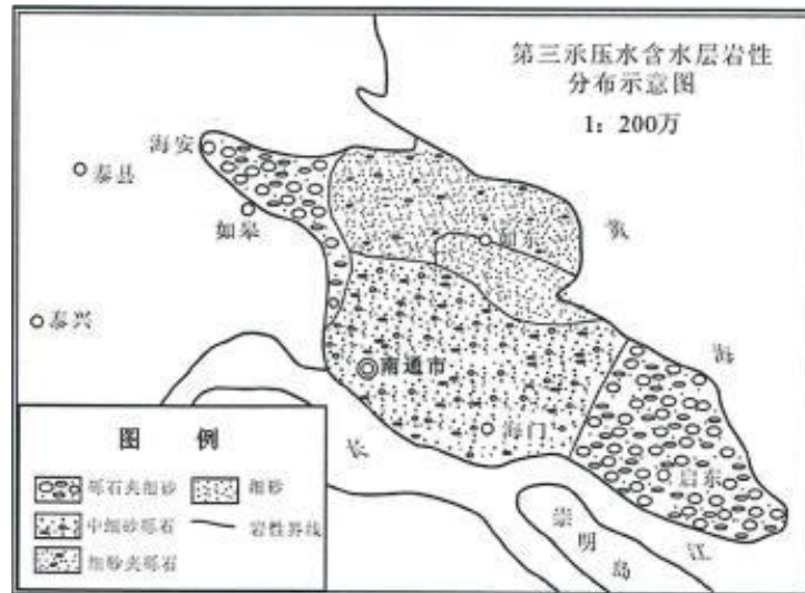
图6.2-4 第三承压水含水层岩性分布示意图
