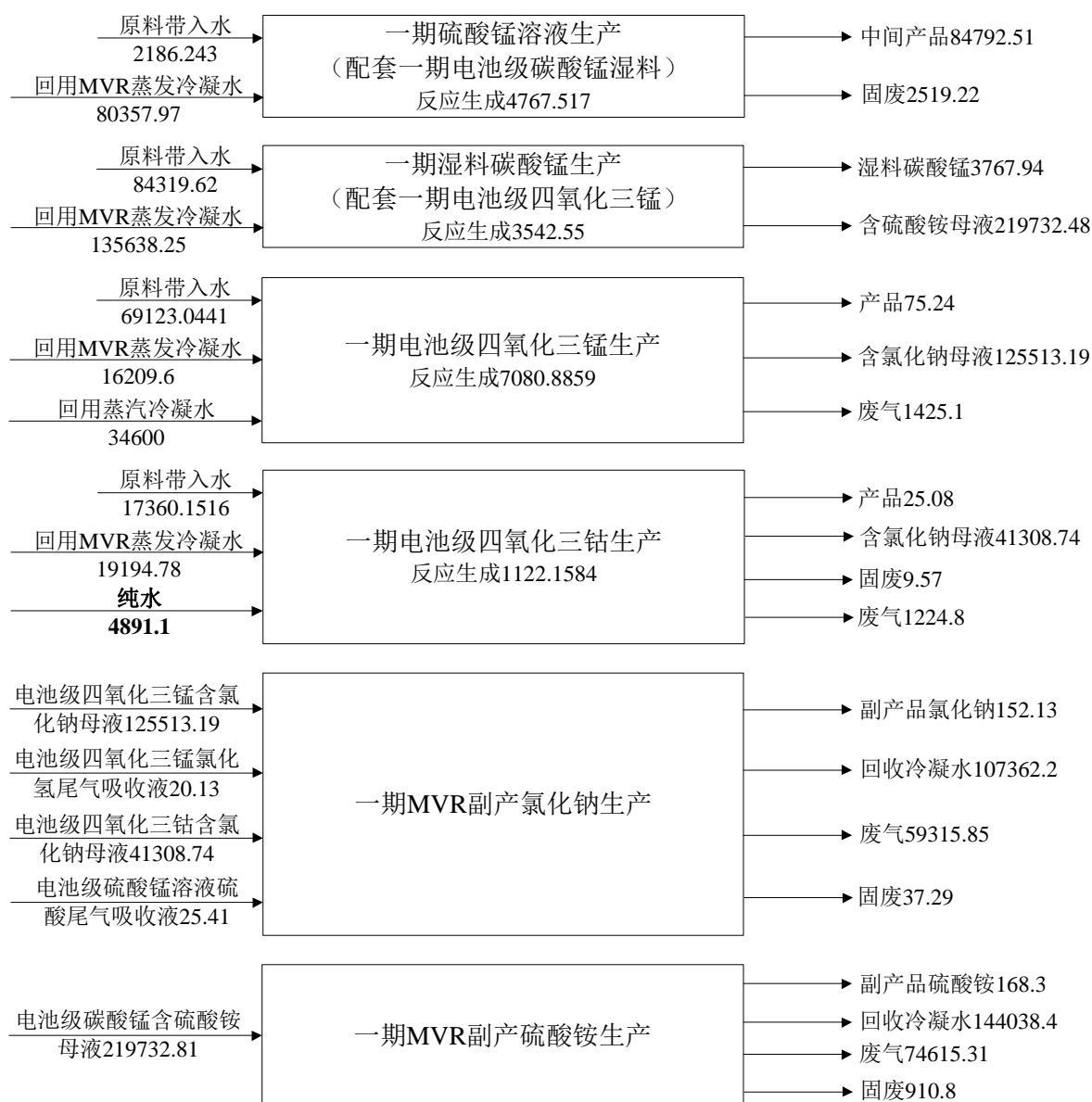
图 3.4-30 一期工程生产工艺水平衡图 (m³/a)
