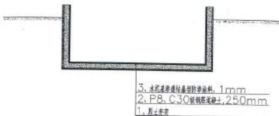
图 6.5-3 废水装置池体防渗结构示意图
