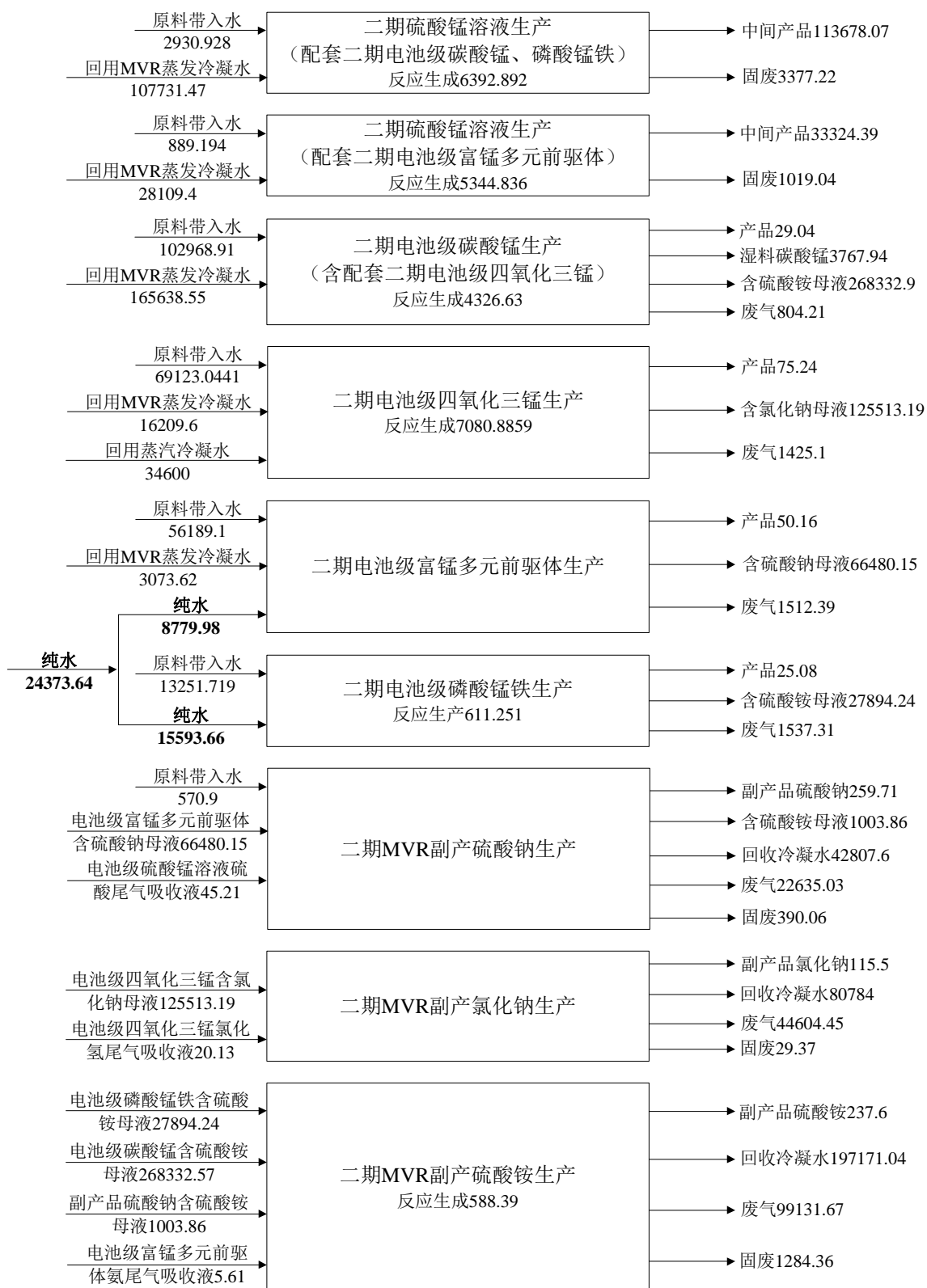
图 3.4-31 二期工程生产工艺水平衡图 (m³/a)
