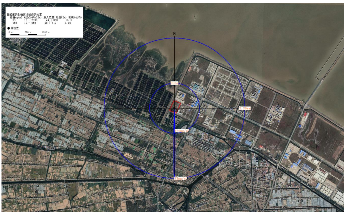
图 5.8-4 31%盐酸储罐泄露事故毒性终点浓度范围图（最不利气象条件）
