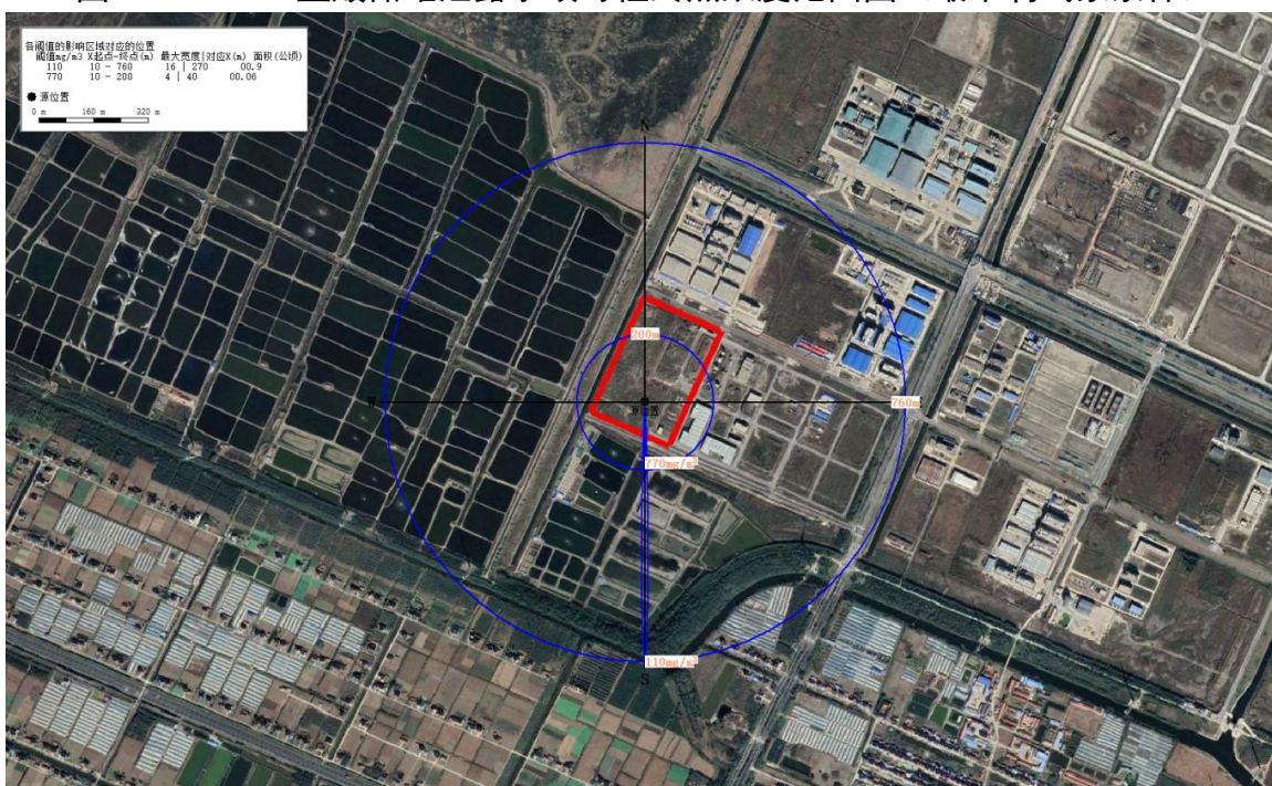
图 5.8-5 20%氨水储罐泄露事故毒性终点浓度范围图（最不利气象条件）
