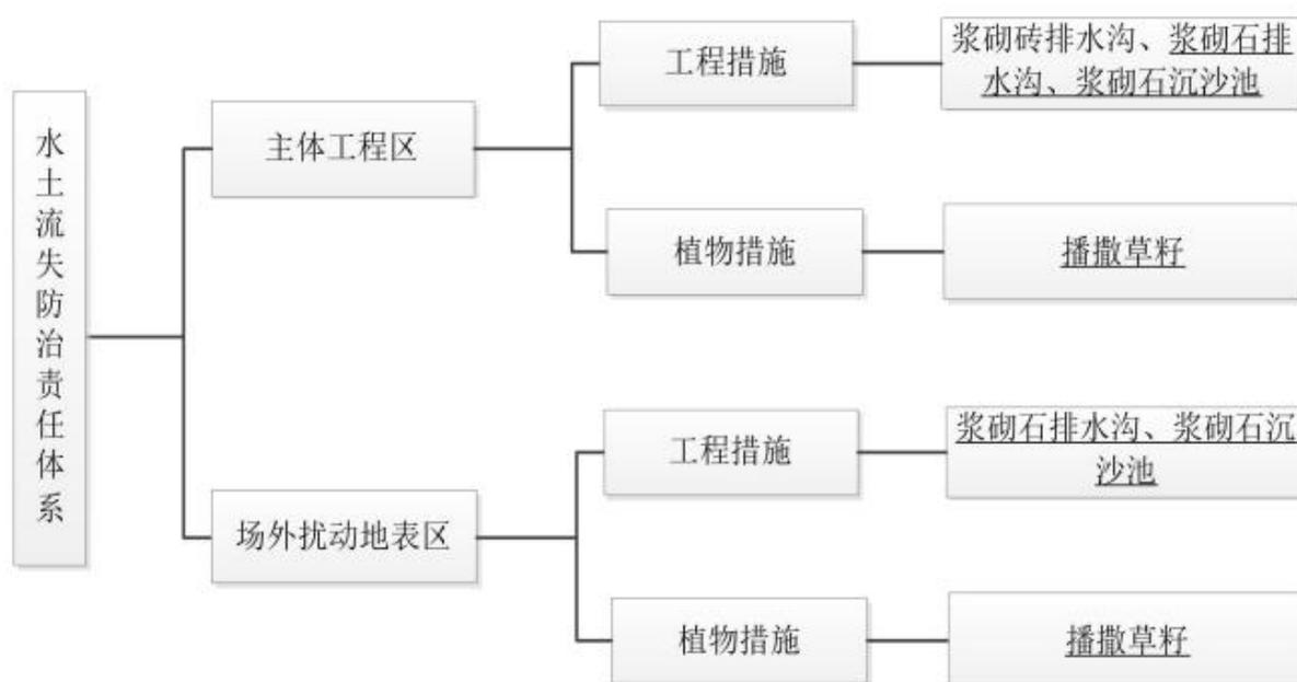
图 6.1.5-1 工程水土流失防治体系框图
