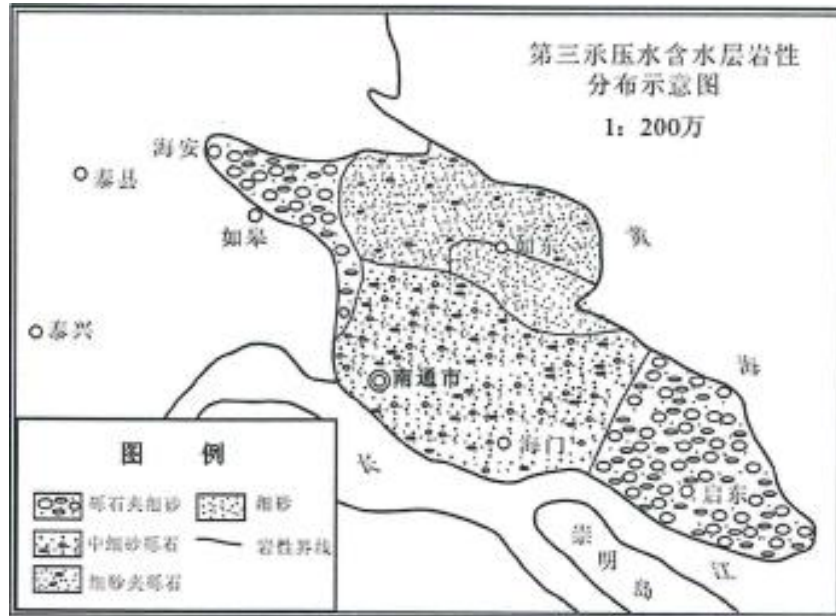
图5.2-5 第三承压水含水层岩性分布示意图
