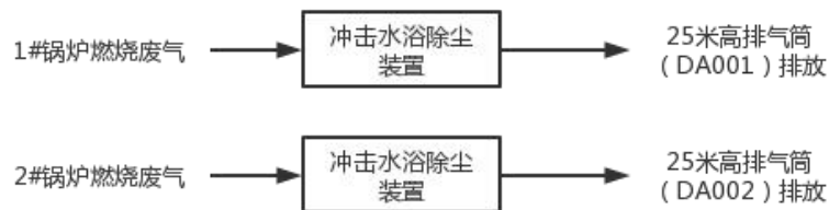
图 5-2 废气处理装置气路图
